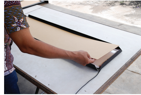
2) Angkat Acrilyc dibagian atas dan tentukan lubang baut.
